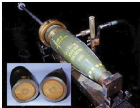
b) Seccionamento por jato de água
