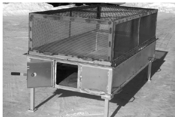
b) Sistema portátil com janela de acesso para limpeza e coleta do resíduo
