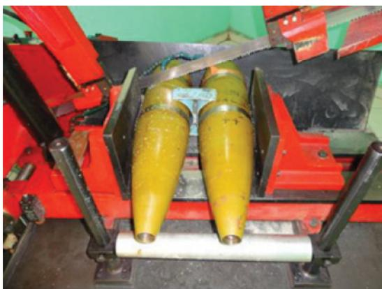
a) Seccionamento por serra
