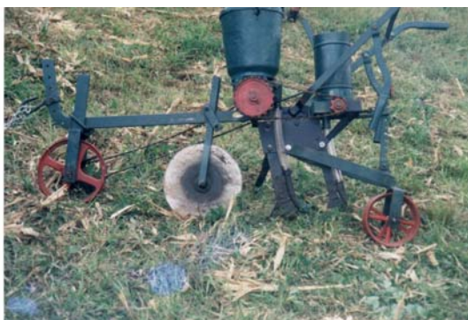
Figura 4.4 - Semeadora adubadora com duplo cinzel. WEISS (1998).
