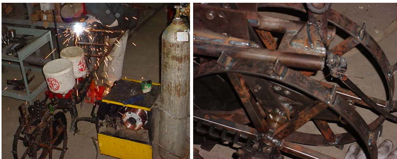
Figura 4.20 – Fabricação do protótipo do implemento.
