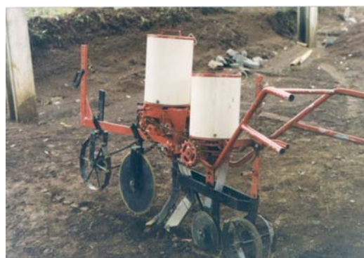
Figura 4.5 - Semeadora adubadora com cinzel para adubo e disco duplo para a semente. WEISS (1998).
