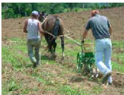
Figura H.9 - Verificação do corte durante a operação de sulcagem com o subsistema de dosagem de adubo montado.
