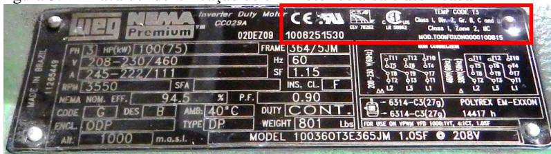
Figura 3.2 - Placa de identificação de um motor de área classificada
