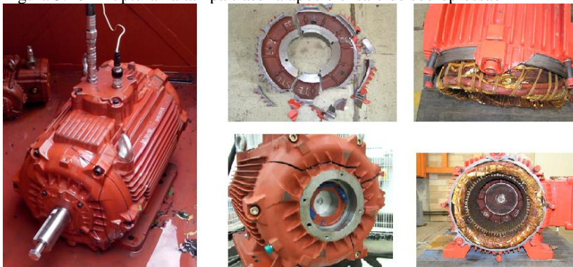
Figura 3.10 - Ruptura na tampa traseira após o ensaio de sobrepressão
