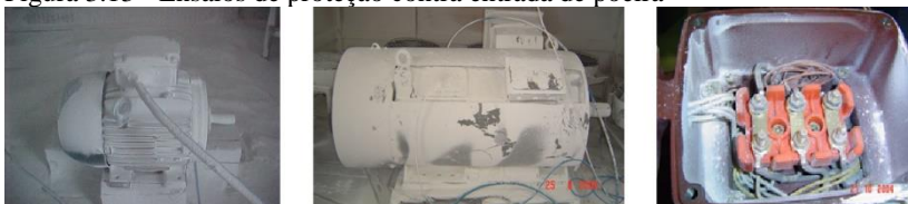
Figura 3.13 - Ensaios de proteção contra entrada de poeira
