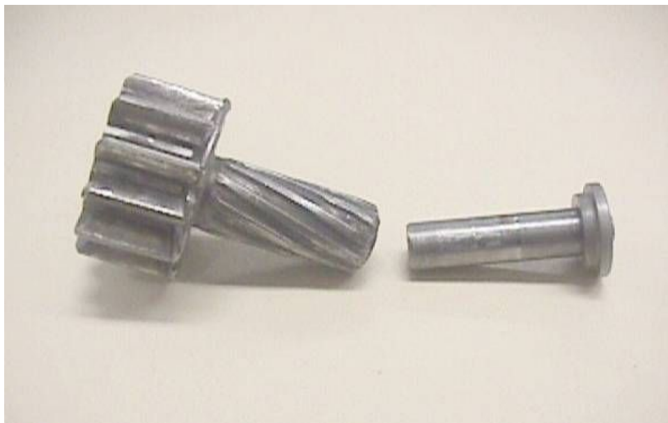
Figura 5.31 –Ruptura do pinhão na Versão 1 do projeto, causada por torção.
