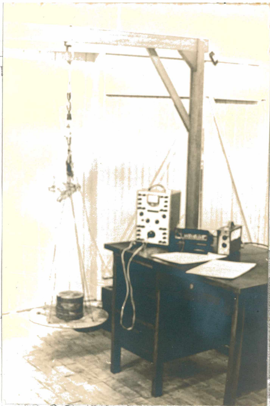
Fig. 4.1 - Vista geral da montagem de teste da determinação do E, G, com uso de extensômetros.
