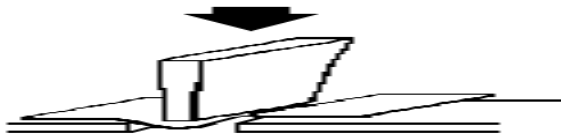
FIGURA 37 - Teste de rigidez, MOURA & BANZATO (1990).
