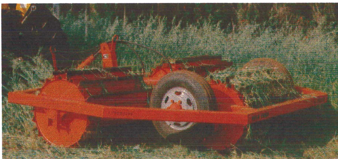
Figura 2. 4 - Rolo-facas tração mecânica. (Fonte: Catálogo IMASA).
