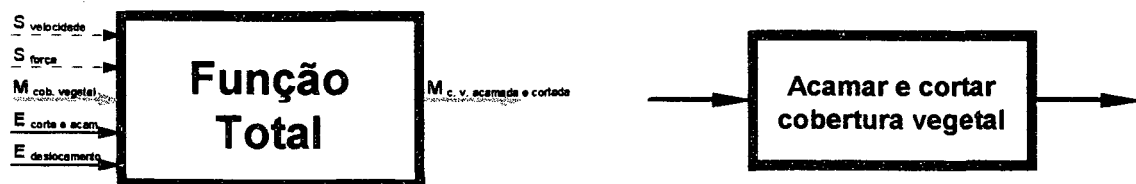
Figura 4. 3 - Função total para equipamento de manejo de cobertura vegetal (2 possíveis representações).
