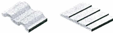
Figura 7.12. Formas selecionadas para a função "guiar cédulas" considerando as informações da matriz de diretrizes de projeto de componentes injetados.
