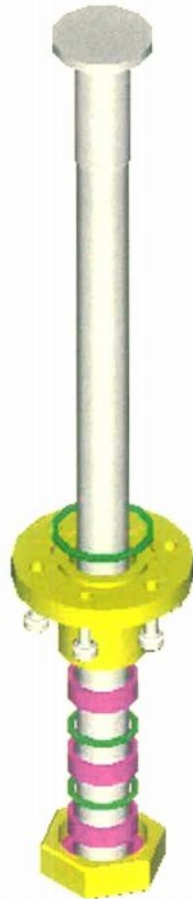
Figura 6.34: Eletrodo montado no passador - vista explodida.
