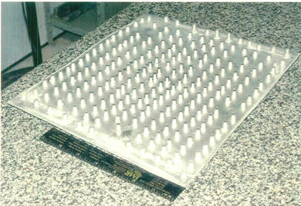
Figura 8.22: Bandeja de peças de FeNiC processadas.
