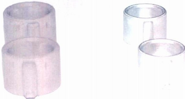
Figura 8.30: Retração dimensional no FeNiC.
