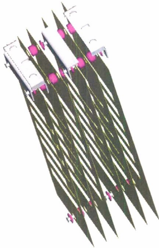
Figura 6.31 Montagem 3D dos anteparos térmicos laterais móveis.
