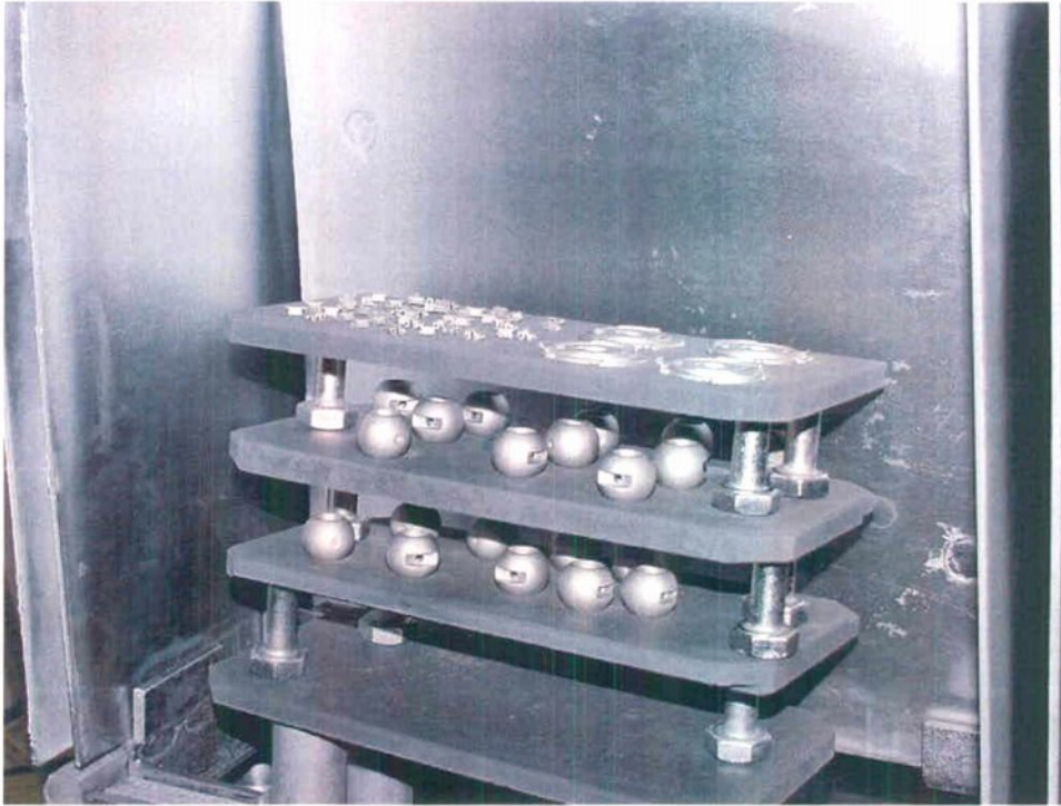
Figura 8.32: Pilha de bandejas contendo os componentes em AISI316L.
