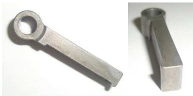
Figura A.6 – Duas perspectivas da palheta do sistema roda-livre.
