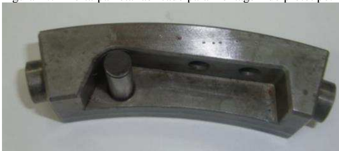
Figura A.7 - Porta-palheta fabricado para montagem do protótipo.
