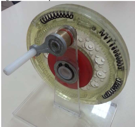
Figura 8.7 – Protótipo em escala da nova interface mecânica AP.
