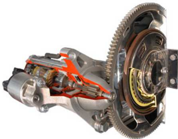
Figura 4.5 – Protótipo de uma Interface Mecânica AP com pinhão-coroa.
