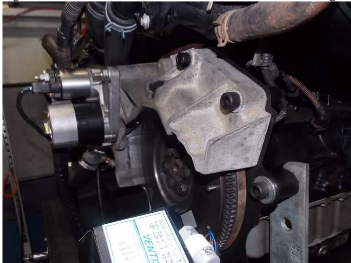
Figura A.11 – Bancada de teste com a interface convencional original.
