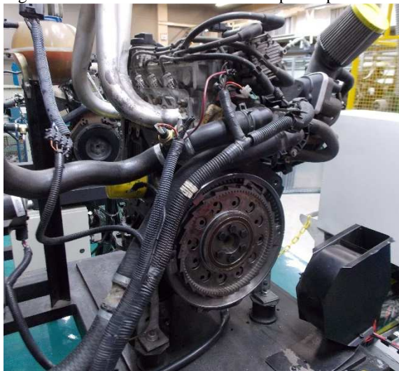
Figura A.13 – Bancada de teste com o protótipo da interface mecânica AP.
