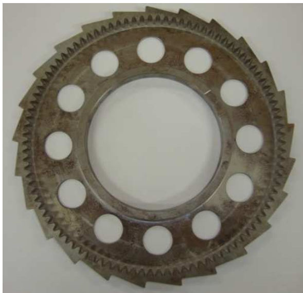
Figura A.5 - Coroa com dentes internos e perfil de catraca externo.
