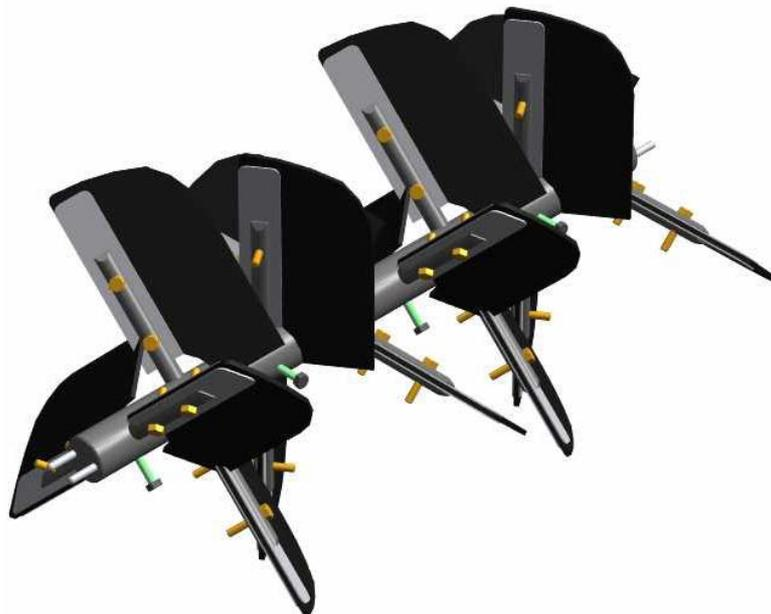
**Figura 7.19** – Novo eixo agitador (M40).
