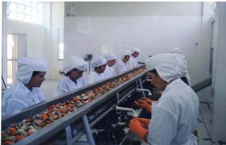
**Figura 2.25** – Esteira utilizada pela COOPERMAC para auxiliar na retirada das conchas dos mexilhões.
