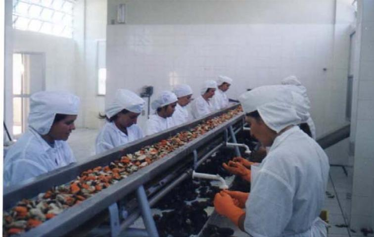
**Análise funcional:** processo de retirada manual das conchas.
