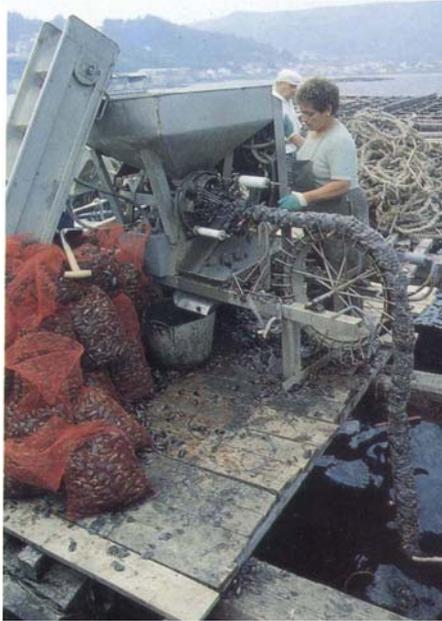
**Figura 2.9** – Encordoamento mecanizado – desdobradora (NEIRA ET AL., 1990).
