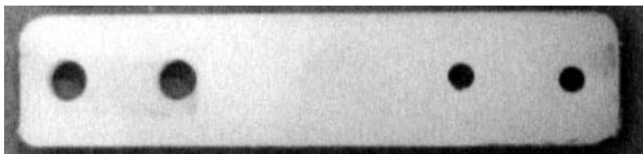
**Figura 7.13** – Correções na furação para fixação das pás.
