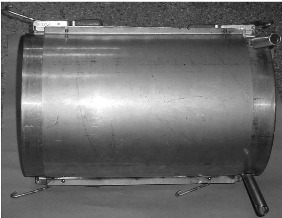
**Figura 7.12** – Novo sistema de fixação dos bojos do extensor separador (M2).
