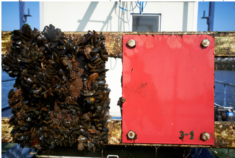
Figura 2-13 – Placa sem biocida (esquerda) e Placa com biocida (direita)
