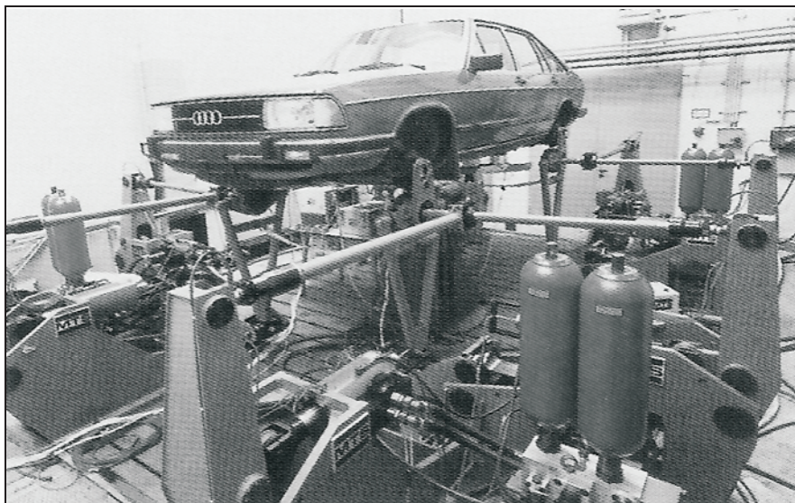
Figura 11.1 Simulador para múltiplos eixos e longo curso (MTS, 1996).
