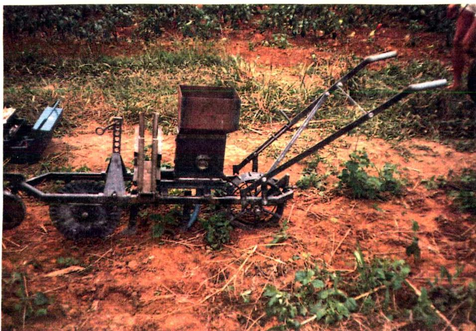
Figura 7.7 - Vista do protótipo, preparado para o terceiro teste com dosador de semente e gaiola porta lastro.
