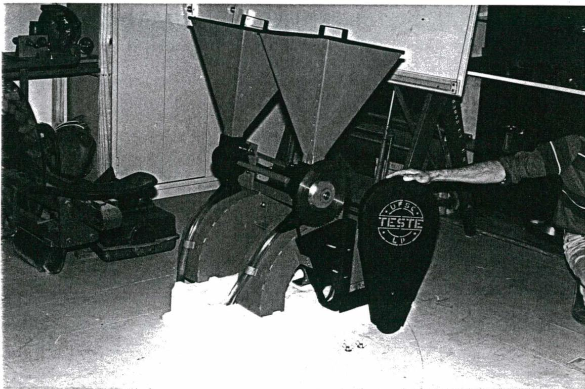
Figura 3.27 - Detalhe da proteção para a corrente.
