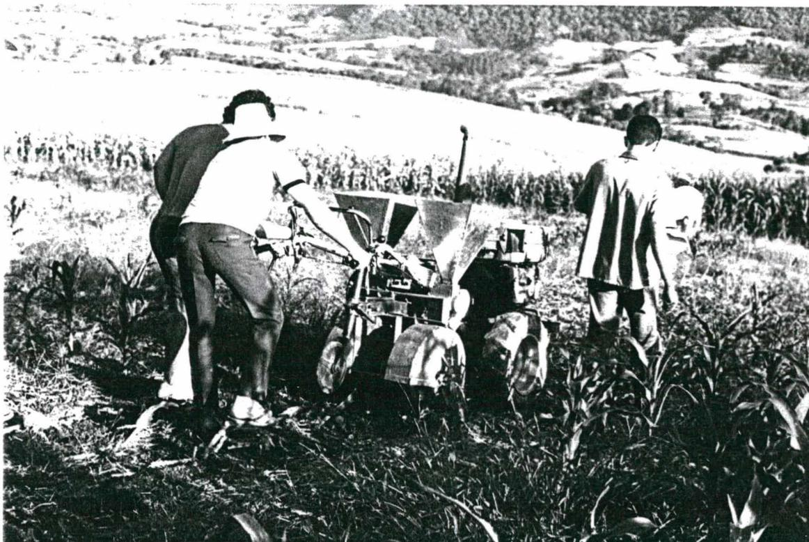
Figura 3.24 - Vista da máquina com os reservatórios de adubo montados.
